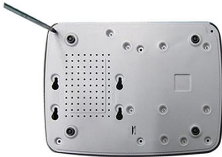
Змацуеце жорсткі дыск на ніжняй панэлі пры дапамозе шруб праз соотвѣтствующие адтуліны.
